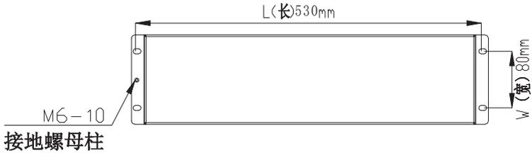
50-7%和50-14%规格安装固定尺寸：L(长) 530mm\*W(宽) 80mm
