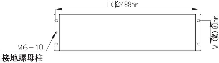
40-7%及以下规格安装固定尺寸：L(长) 488mm\*W(宽) 80mm
